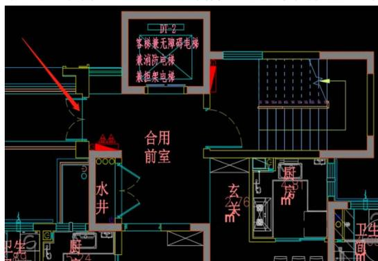
答：图中直接开向室外的普通外门可计入自然通风面积。
